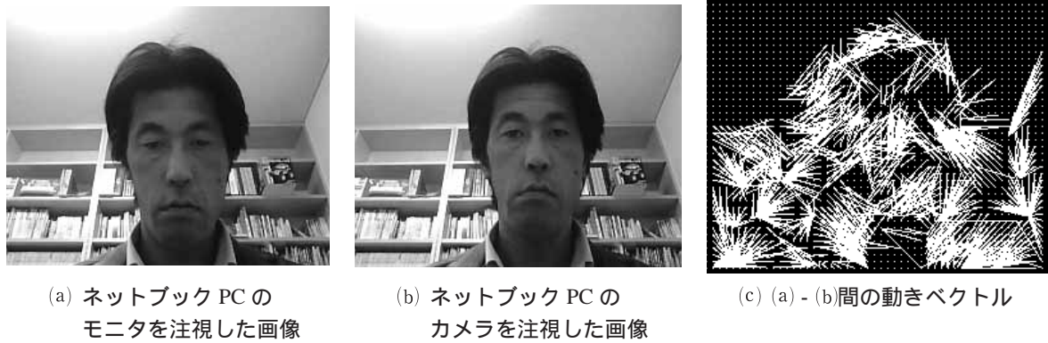
図4 実際の画像から取得した動きベクトル (撮影 EeePC 130万画素、速度ベクトルを計算する画素間の距離：5の場合)
