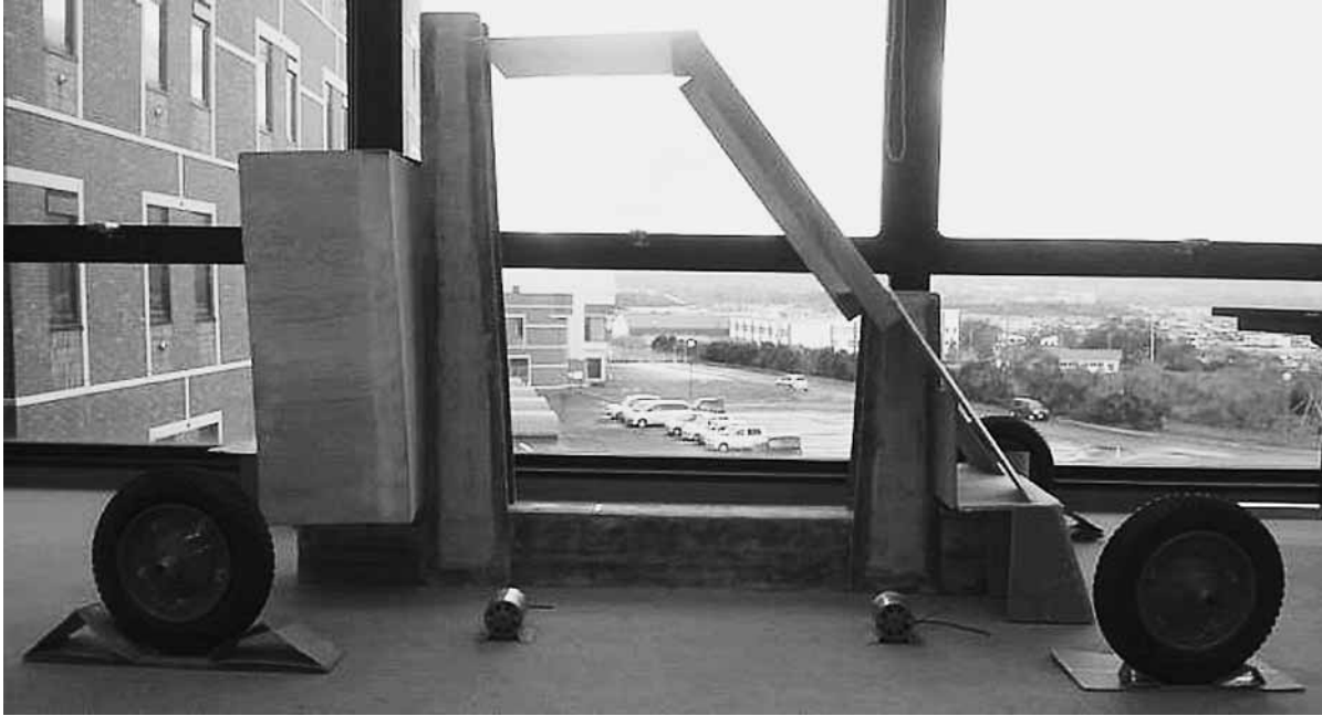
図1：2013年度の超小型電気自動車開発の進捗状況ーバックボーン・フレームの前方に風防のオス型を組み付け、モータとタイヤ、そしてラゲッジスペースを兼ねる電源部をレイアウトしたもの。
